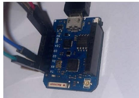
Figure 15. Nó ponte com ligação GPIO para o nó central.
