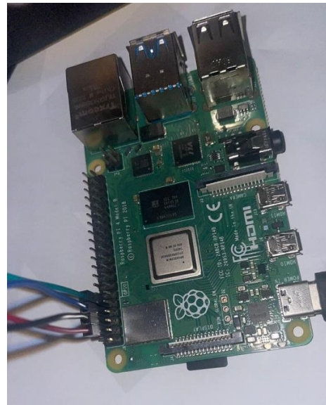
Figura 14. Nó central com ligação GPIO para o nó ponte.
